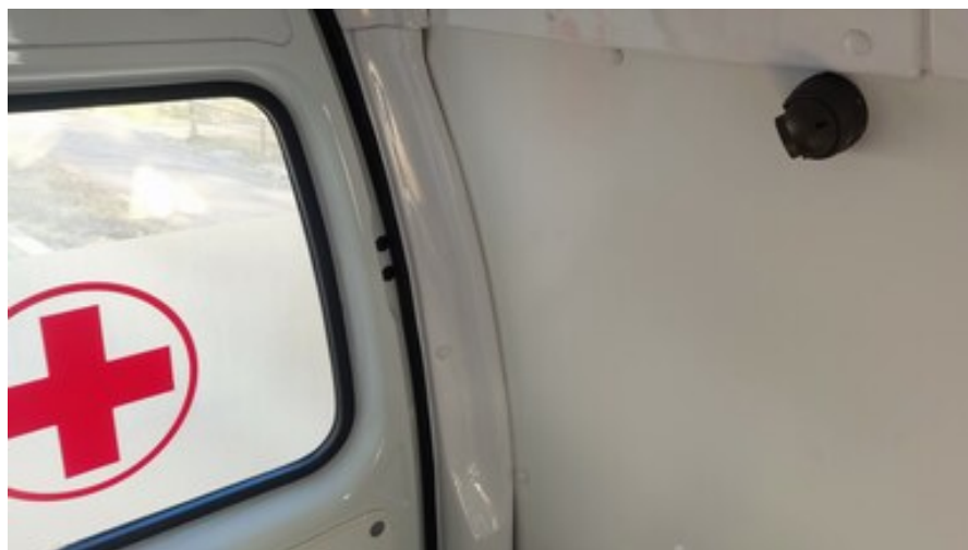
Установка системы видеонаблюдения на части машин, с которых осуществляется погрузка лежачего больного в автомобиль
