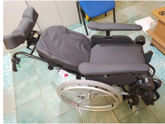
специальная инвалидная коляска с откидывающейся спинкой и выпрямляющимися подставками под ноги для транспортировки лежачих больных
