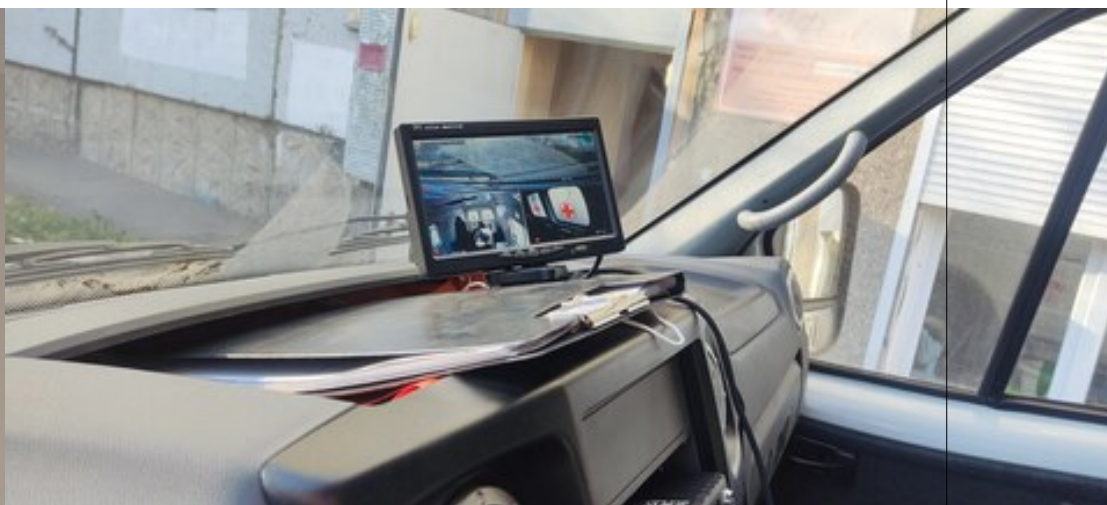
Вывод внешнего и внутреннего видеонаблюдения на экран-монитор, установленный на центральной панели автомобиля
